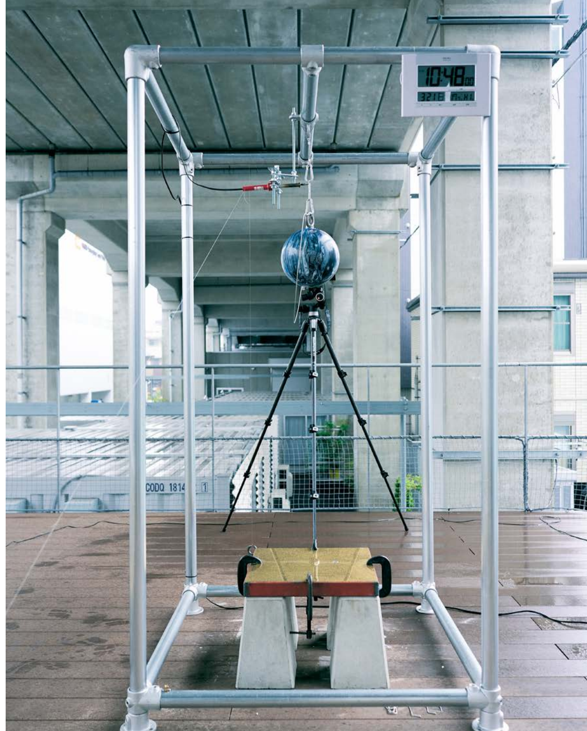
《D.等しい体積の異種金属板の落下衝撃試験及び14ポンドのボーリング球を用いたはんだのクリープ試験—はんだは鉛50%すず50%とする》 はんだのフックで吊り下げられたボーリング球を落下させ、異なる金属板の変形の違いを観察する装置（落錘試験がモチーフ）。 自重によってはんだのフックが切れ、ボーリング球を落下させる方法（クリープ試験をモチーフ）と、 近くに設置してある体重計と連動して動くはんだごとをフックに直接あてて落下させる二つの方法がある。
